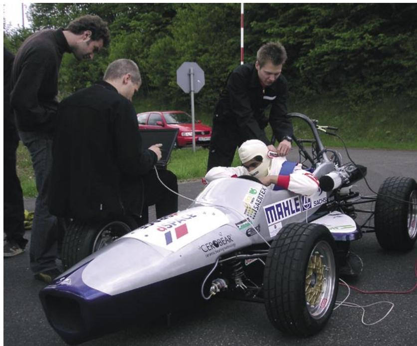
◀ Mit Hilfe des Flight Recorders der MicroAutoBox wurden während der Straßentests Daten erfasst, um sie später auszuwerten. So wurden Fehler im Reglermodell aufgedeckt.
