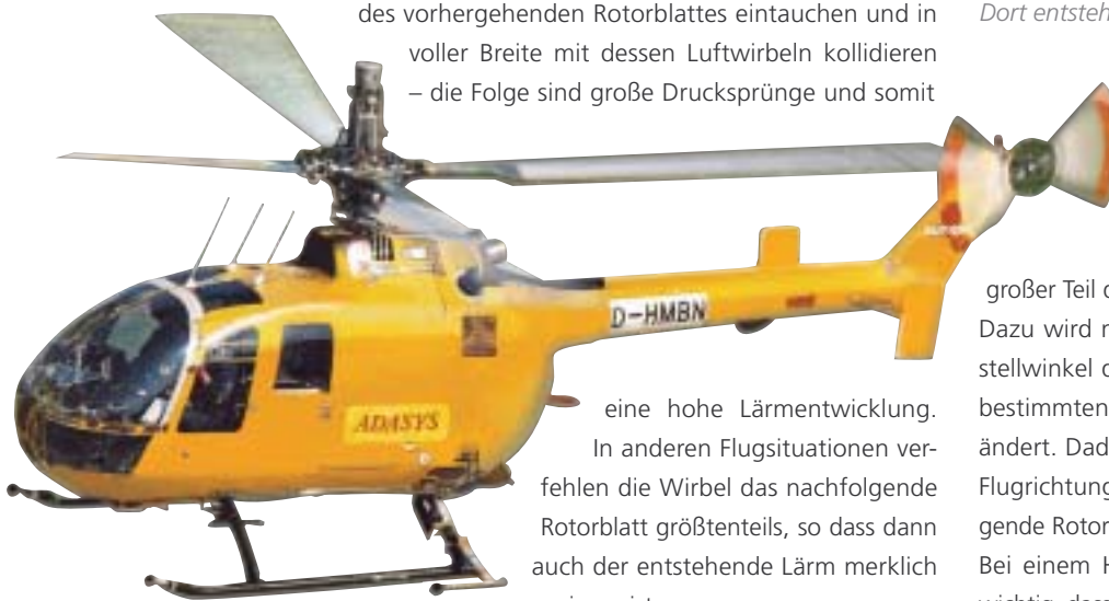
▲ Der Hubschrauber vom Typ BO 105. An den Landekufen befinden sich Mikrofone zur Schallmessung.
