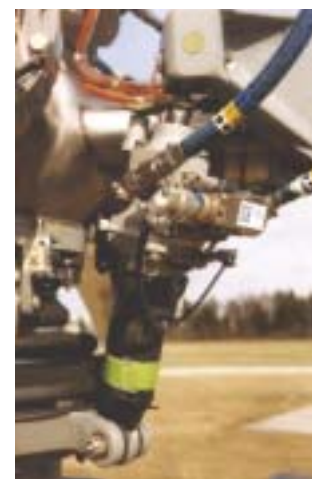
▲ An jedem der 4 Rotorblätter befindet sich ein Aktuator zur Anstellwinkeländerung.
