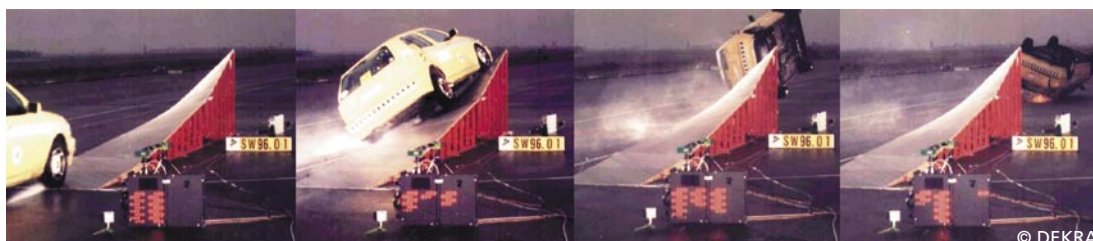
▲ In solchen Situationen löst der WinGAMR Algorithmus zur Überrollerkennung die Sicherheitsmaßnahmen aus.
