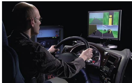
▲ テストドライバーは実際のステアリングホイールを操作しながら、トラックの挙動をスクリーンで見ることができます。
