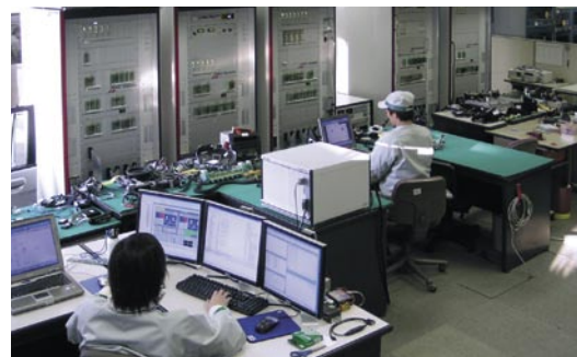
▲ ラボに設置されたバーチャルビークルテストシステム
