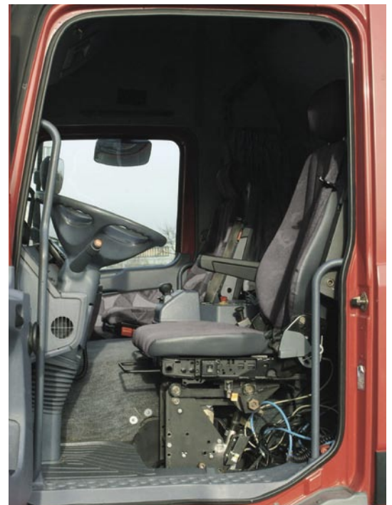
▲ 運転席に組み込まれたアクティブシートサスペンションのプロトタイプ
