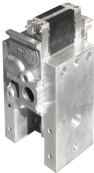
▲ バルブのテストベンチの基部は、量産用シリンダヘッドの一部です。バルブに作用する気体の力は、気圧によってシミュレートされます。
