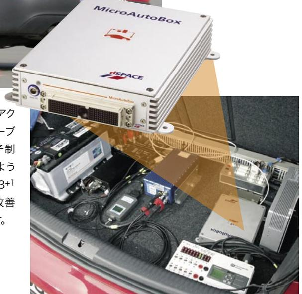
▲ テスト車両のトランク内に取り付けられた MicroAutoBox
