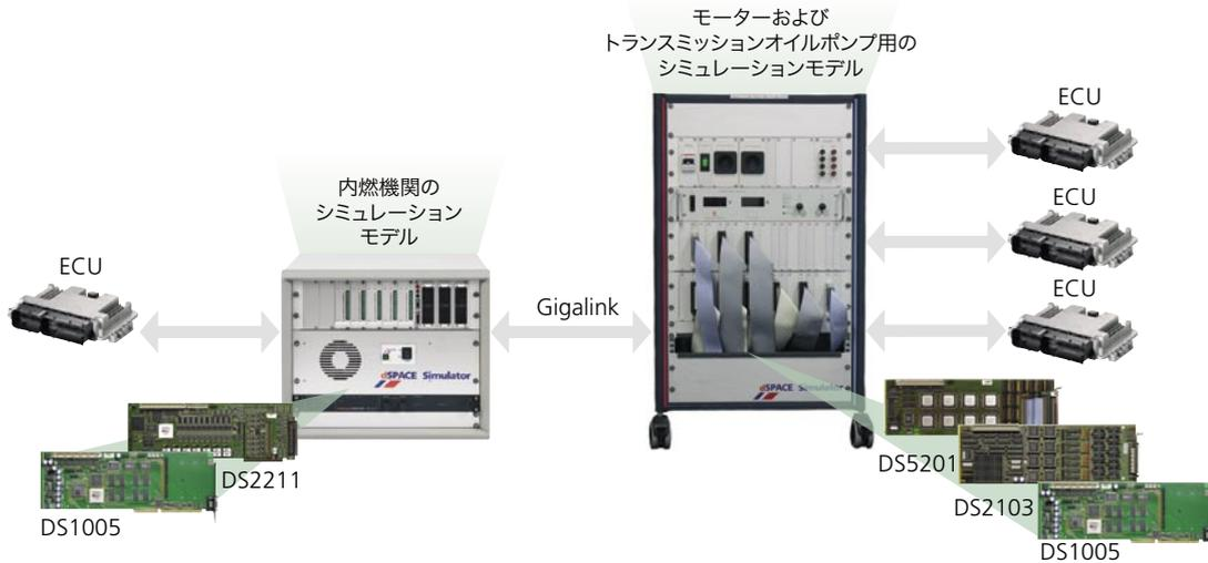
▲ 内燃機関と電気モーターをシミュレートする dSPACE シミュレータカスタマイズ
