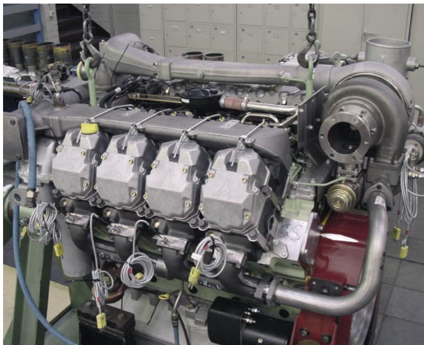
▲ Deutz 製 TCD2015 V8 4V は、重量約 1280 kg、最大トルク 3050 Nm のディーゼルエンジンです。
