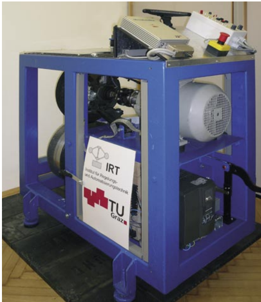
▲ MicroAutoBox と操作コンソールを使用したテストベンチ
