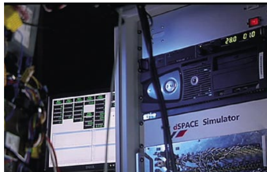
▲ その他の取り付けられていないトラックの部品については、dSPACE の HIL シミュレータが再現します。
