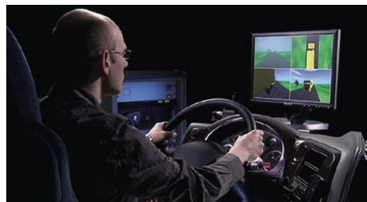
▲ Der Testfahrer hat ein reales Lenkrad und beobachtet das Verhalten des Lkws auf einem Bildschirm.
