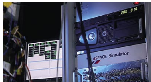
▲ Der dSPACE-HIL-Simulator simuliert die fehlenden Teile des Lkws.
