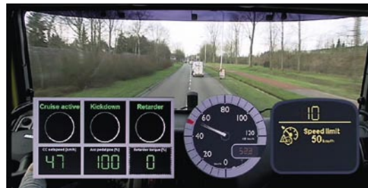
▲ Zum Überholen überstimmt der Fahrer die Safe-Speed-Funktion.
