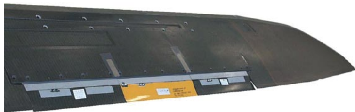
▲ Die Rotorblattspitze mit den Zusatzklappen. Die ca. 35 Klappenausschläge pro Sekunde regelt Eurocopter mit Hilfe eines dSPACE-Prototyping-Systems.
