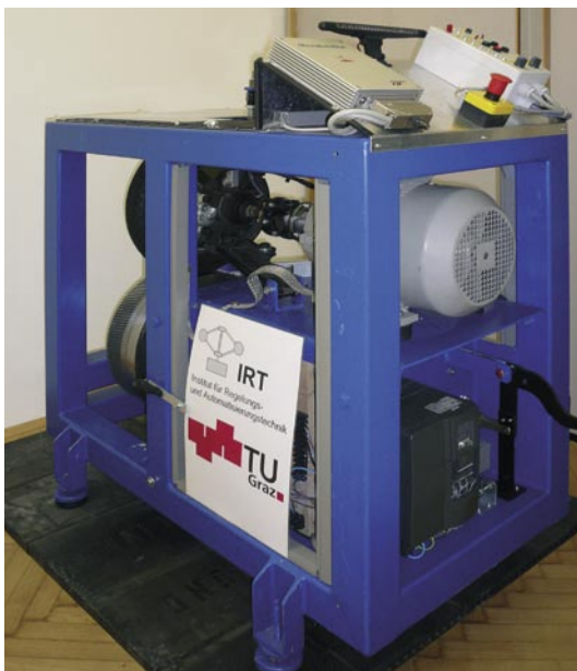
▲ Aufbau des Prüfstands mit MicroAutoBox und Bedienkonsole.
