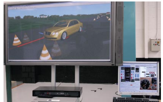
▲ MotionDesk visualisiert Fahrmanöver während Driver-in-the-Loop-Tests.
