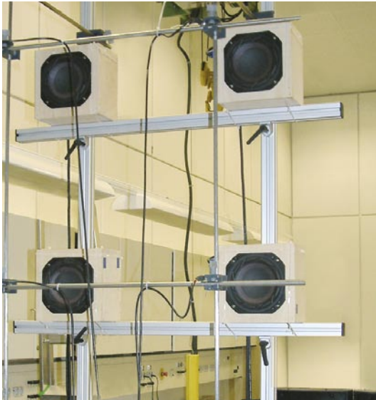
▲ Experimenteller Aufbau einer Lautsprecher-Fehlermikrofon-Anordnung zur aktiven Schallreduktion.
