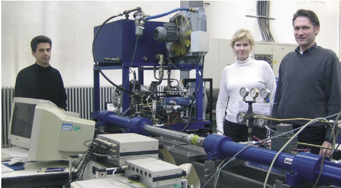
◀ Am stationären Versuchsstand: Das Forscherteam analysiert den Einfluss von Luft in einem Arbeitshydrauliksystem einer mobilen Arbeitsmaschine. Von links: Björn Grösbrink, Julia Lechnitz, Thomas Fedde.
