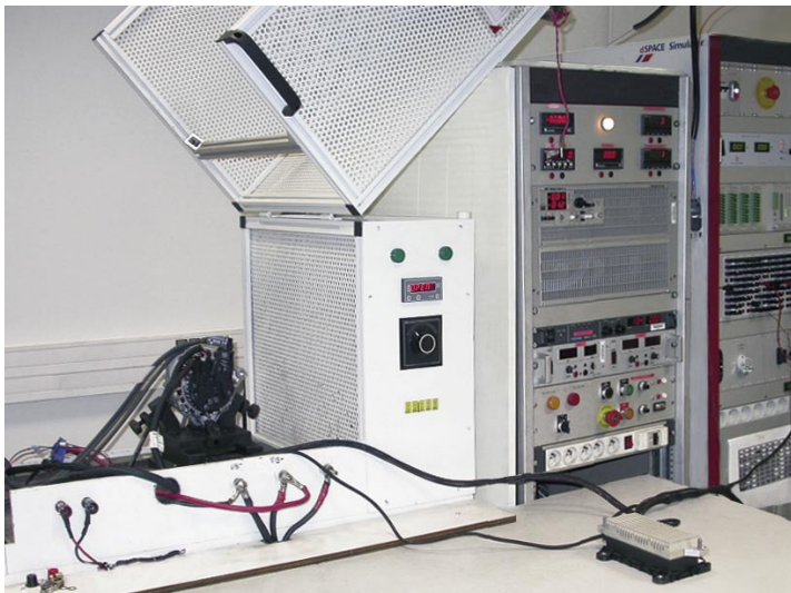
▲ Der Validierungsprüfstand basierend auf einem dSPACE Simulator Full-Size.
