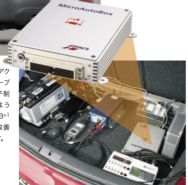
▲ テスト車両のトランク内に取り付けられた MicroAutoBox
