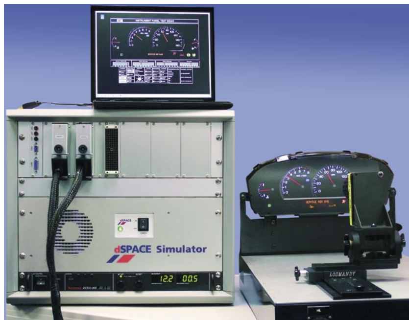
▲ カメラ (右) がインストルメントクラスタを「観察」し、信号を HIL シミュレータに渡します。
