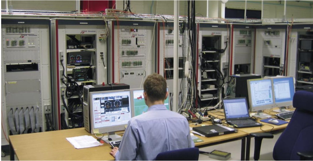
◀ Scania 社で使用される ネットワーク化された HIL (Hardware-in-the-Loop) シミュレータ
