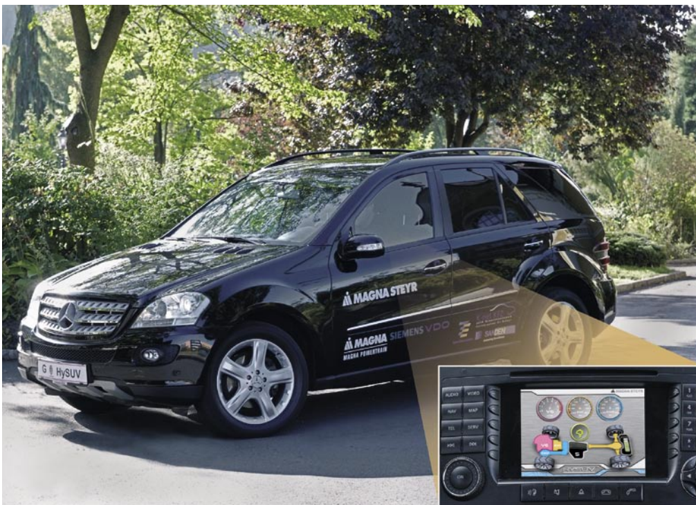
▲ Hybrid-Fahrspaß mit dem Demo-Fahrzeug HySUV (modifizierter Mercedes ML350): Auf einem Display im Inneren können Fahrer und Fahrgäste während der Fahrt live beobachten, wie der Momentenfluss über die drei Antriebsaggregate gesteuert wird.
