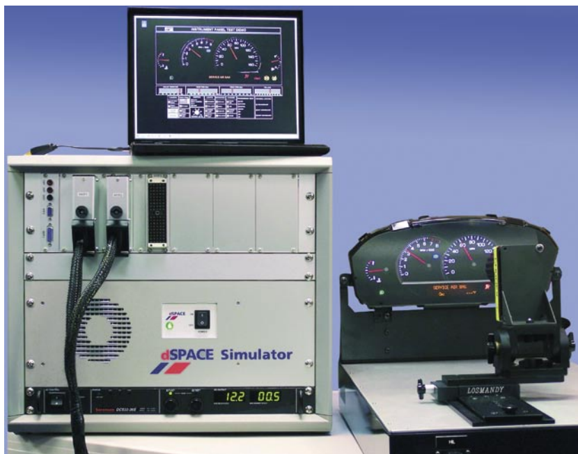
▲ Die Kamera (rechts) „beobachtet“ das Kombiinstrument und leitet die Signale an den HIL-Simulator weiter.
