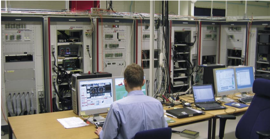
◀ Die Hardware-in-the-Loop-Simulatoren im Verbundsystem bei Scania.
