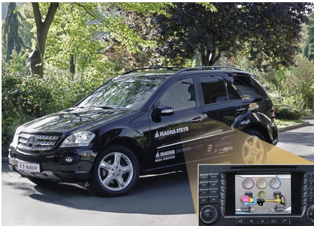
▲ Hybrid-Fahrspaß mit dem Demo-Fahrzeug HySUV (modifizierter Mercedes ML350): Auf einem Display im Inneren können Fahrer und Fahrgäste während der Fahrt live beobachten, wie der Momentenfluss über die drei Antriebsaggregate gesteuert wird.
