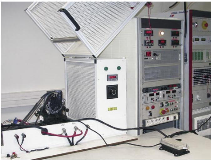
▲ dSPACE Full-Size シミュレータに基づく妥当性確認ベンチ
