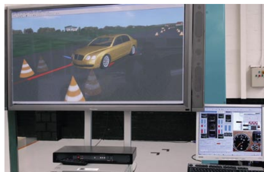
▲ Driver-in-the-Loop テスト中に MotionDesk で 視覚化された運転操作
