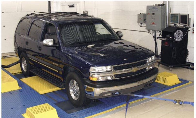
▲ ローレンス工科大学の4WD車用シャーシダイナモは、革新的な自動車工学ソリューションを探る学生たちにとって格好のプラットフォームを提供します。
