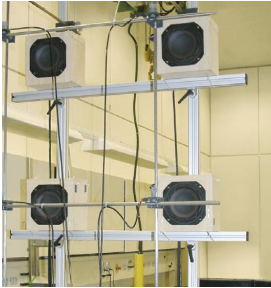
▲ アクティブ騒音低減用のラウドスピーカー／エラーマイクシステムの実験装置
