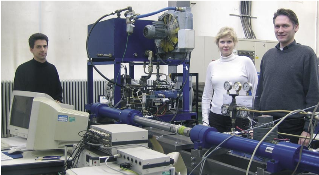
◀ 試験施設に設置されたテストベンチ：研究チームは、移動式の作業機械の操作用油圧システムにおける空気の影響を分析しています。左から Björn Grösbrink, Julia Lechnitz, Thomas Fedde
