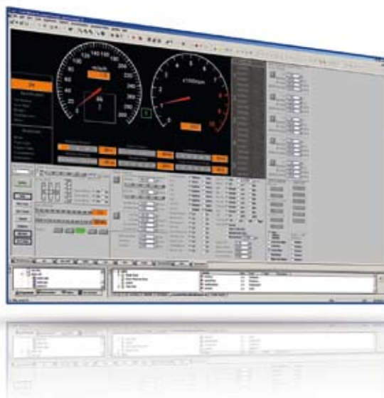
ControlDesk で ACC 信号を制御するグラフィカルインターフェース
