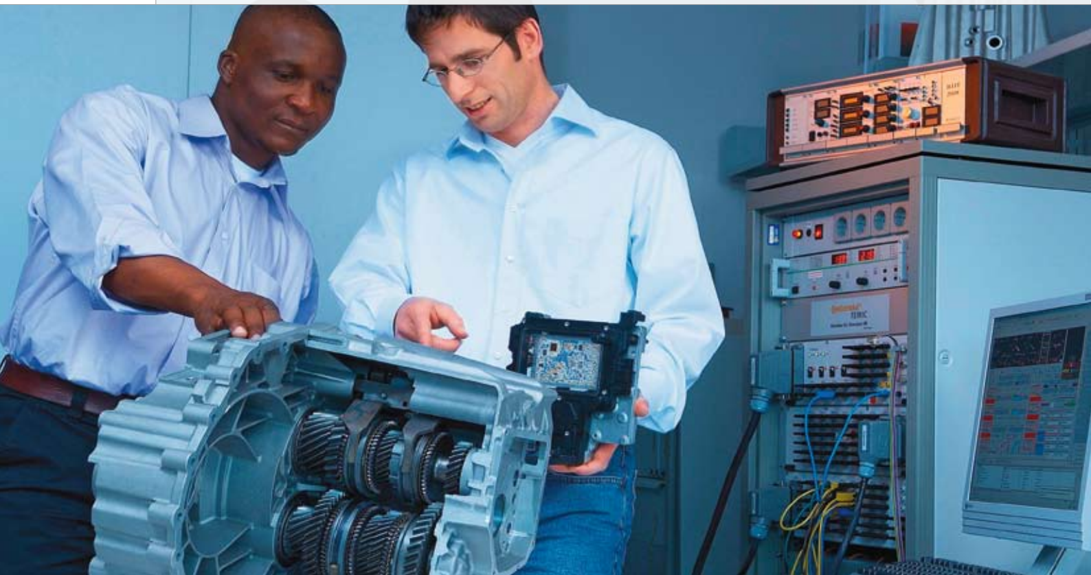
デュアルクラッチトランスミッションは、マニュアルトランスミッションのエネルギー効率とトルクコンバータトランスミッションの快適性を兼ね備えています。
