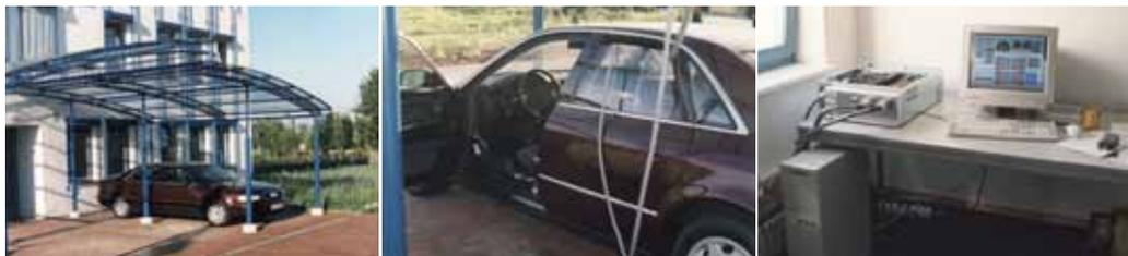
1995 年の最初のターンキー HIL シミュレータ。シミュレータ (TMS320C40 DSP をベースにしたマルチプロセッサシステム、Tesis モデル使用) からのケーブルを 2 階の窓から車両まで降ろし、ABS と電子制御式ディファレンシャルをテストしました。ワークフローは、「車両に乗り込む エンジン始動 走行 (定常モード) ブレーキをかけ ABS を作動」です。この Audi 8 は借り受けたもので、鎖でつないでおく必要がありました。
