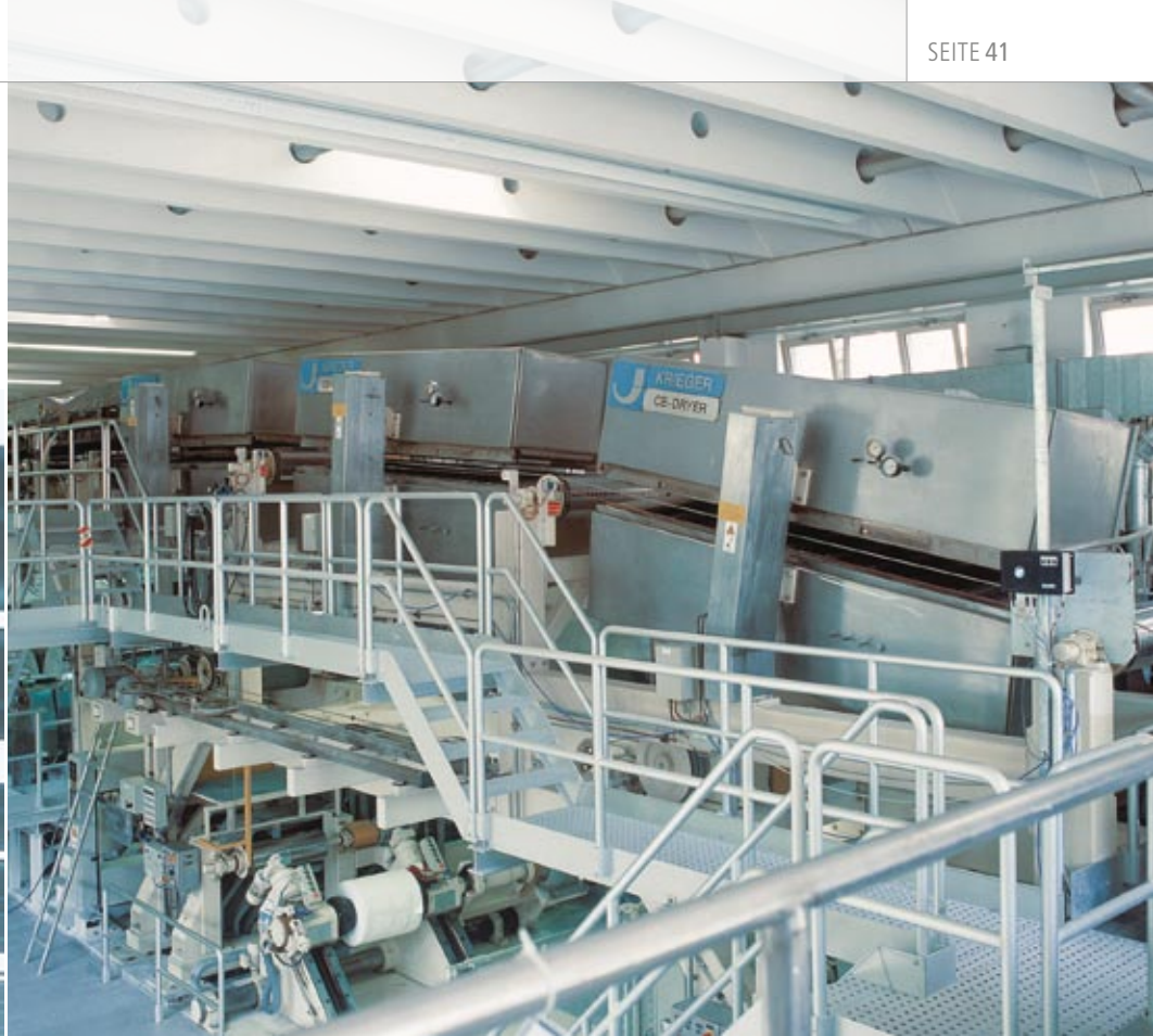
Abbildung 1: Papierstreichanlage VESTRA – Pilot-Coater der Papiertechnischen Stiftung, München.
