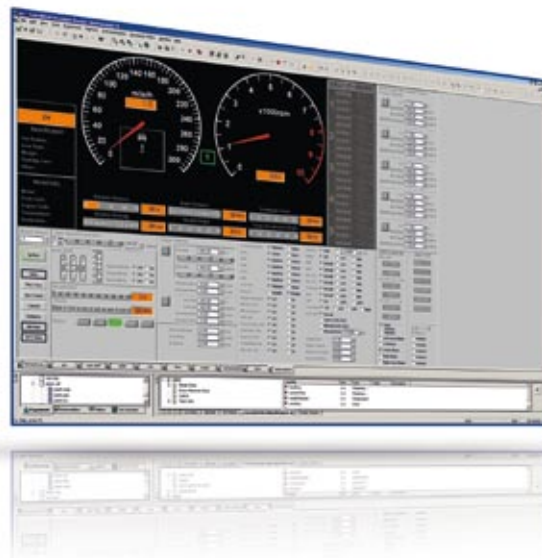
Direkte Steuerung und Darstellung von ACC-Signalen in ControlDesk.
