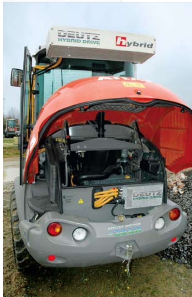
外観上、標準的なホイールローダーと異なる部分は、ルーフに搭載されたリチウムイオンバッテリーのみです。
