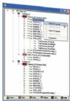
図 2 : CAN Navigator は ControlDesk で CAN を操作するための中心的なアクセスポイント
