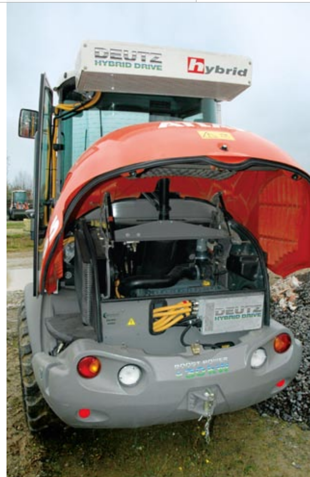
Äußerlich ist der einzige Unterschied zum Standard-Radlader die am Dach angebrachte Lithium-Ionen-Batterie.
