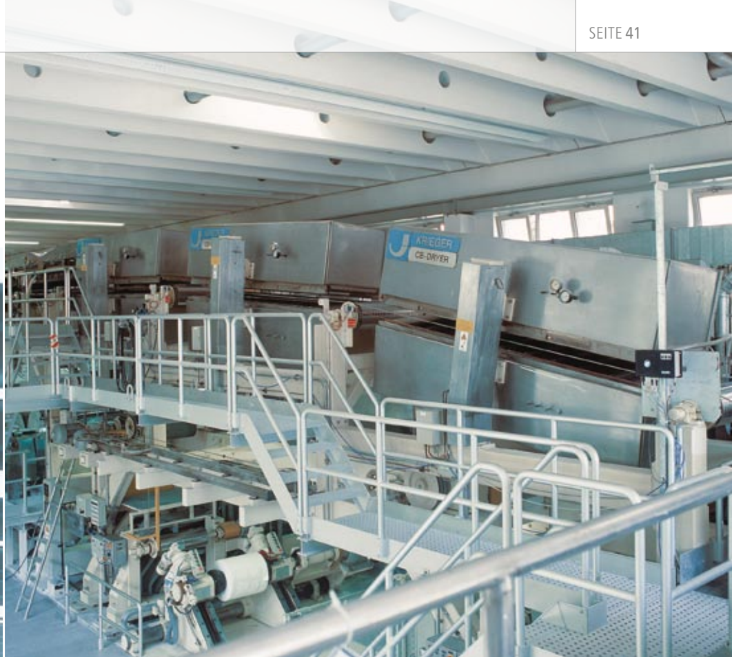
Abbildung 1: Papierstreichanlage VESTRA – Pilot-Coater der Papiertechnischen Stiftung, München.
