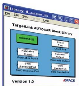
Bild 6: Die Funktionsmodellierung erfolgt unter Verwendung der AUTOSAR-Blöcke von TargetLink.
