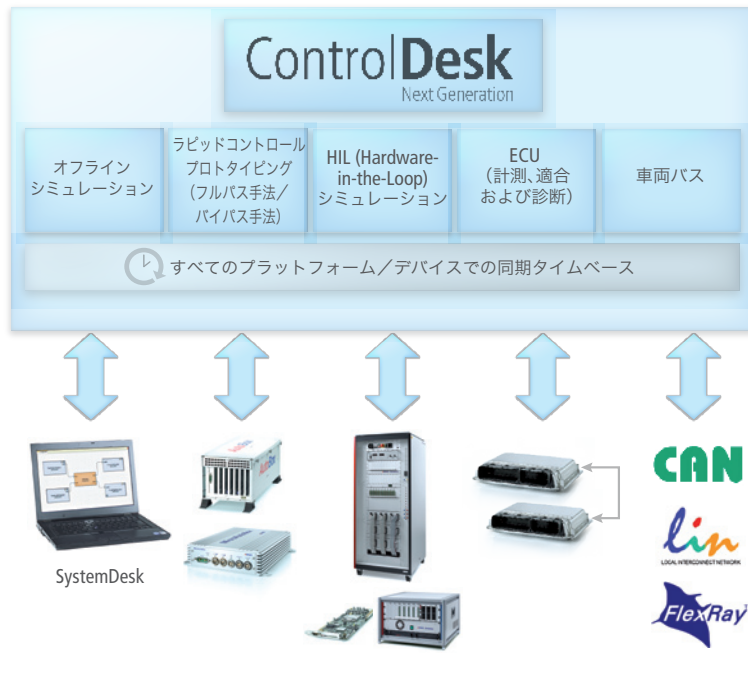
図2：ControlDesk Next Generation、ECU 開発のための汎用的でスケラブルな試験用ツール
