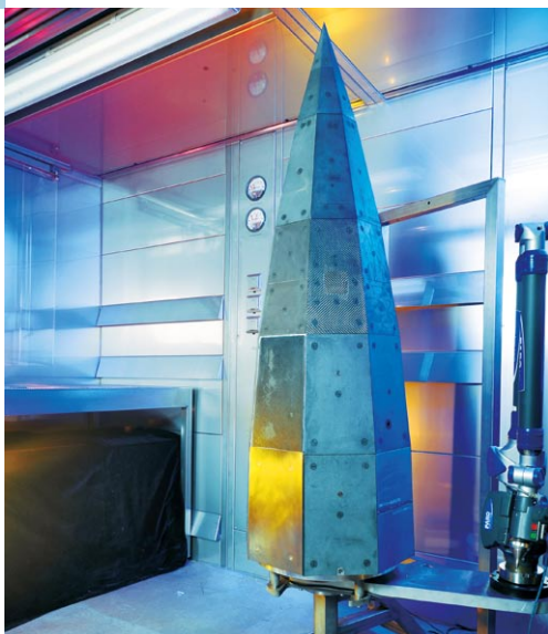
Abbildung1: Links: Die gut 2 m lange, mit flachen Hitzeschutzkacheln belegte Nutzlastspitze. Rechts: Montage der Kacheln. Unter den Kacheln befinden sich u.a. Temperatur- und Drucksensoren für Messungen während des Fluges.
