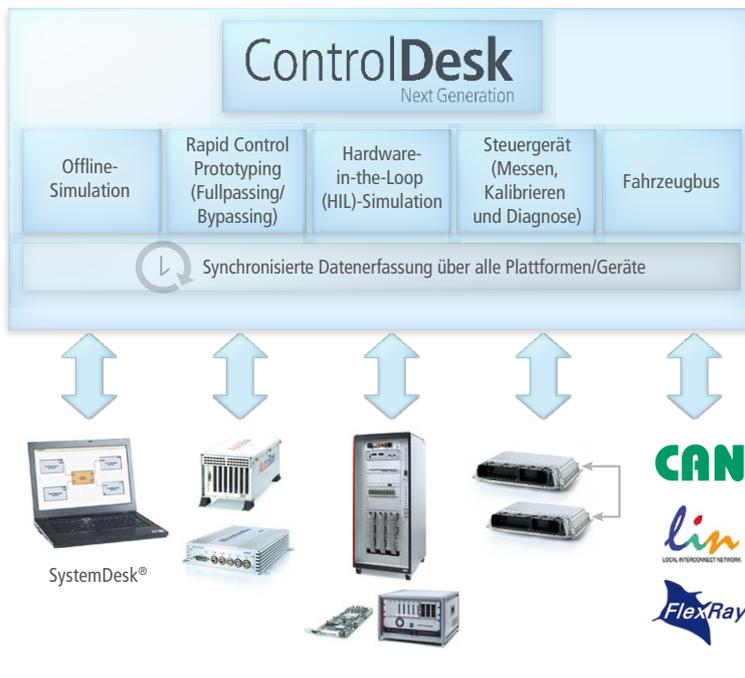
Abbildung 2: ControlDesk Next Generation als neues, universelles und skalierbares Experimentierwerkzeug für die Steuergeräteentwicklung.
