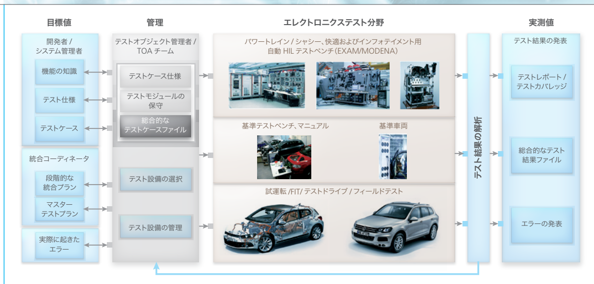
図2：エレクトロニクステスト設備の構成
