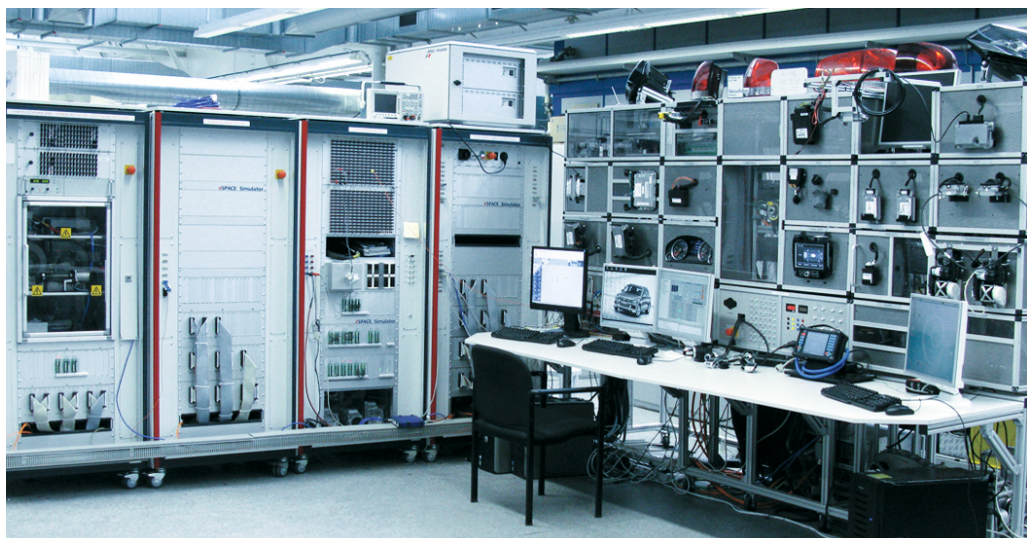
図 4：試験施設でのシミュレータおよびテストベンチのセットアップ
