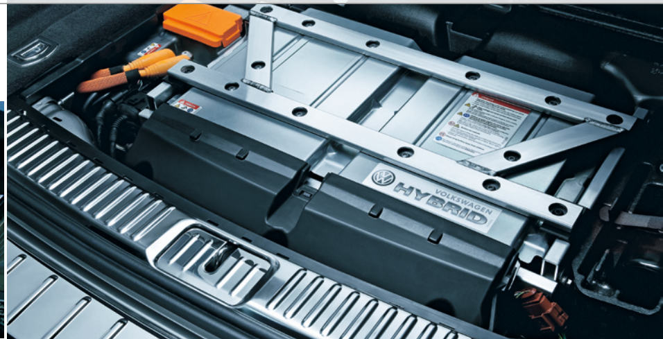
後部に搭載されているニッケル水素 (NiMH) バッテリ
