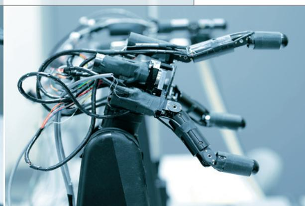
システムとなっています。スローイングロボットは、人間と同様に指を使って、瞬間的にリリースのタイミングと方向を精密にコントロールすることでストライクゾーンへの投球を実現しています。任意に設定した目標地点へ投球することも可能です。バッティングロボットは、アクティブビジョンで計算した3次元位置情報に合わせてバットの軌道も1kHzごとに調整しているため、たとえば変化球や人間がランダムに投げた場合でも打ち返すことが可能です。今回の実験では2台のロボット間の距離が短いため（実験室が狭いため）、バッティングのスウィング時間に合わせて投球速度を制限していますが、実際のピッチャーマウンドとホームベースの距離（18.4 m）に換算すると、理論上は時速300 kmのボールを打つことも可能です。
