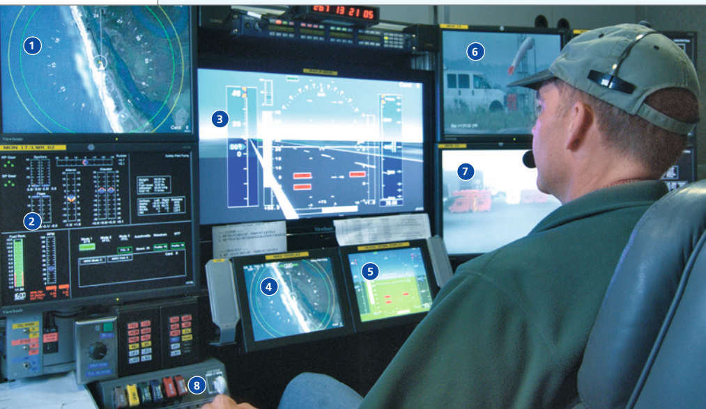
図2：テストパイロットステーション。dSPACE システムが、UAV 機と無線通信をしながら、継続的にリアルタイムの計算タスクを実行することにより、テストパイロットが望む操作をすべて地上から実現できるようになっています。
