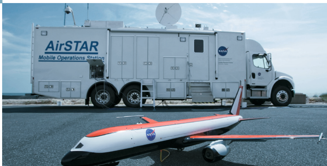
図 1 : UAV 機 (移動地上局の前から撮影) によるテスト飛行は、旅客機の飛行制御コンピュータ用の機能を最適化するのに役立ちます。
