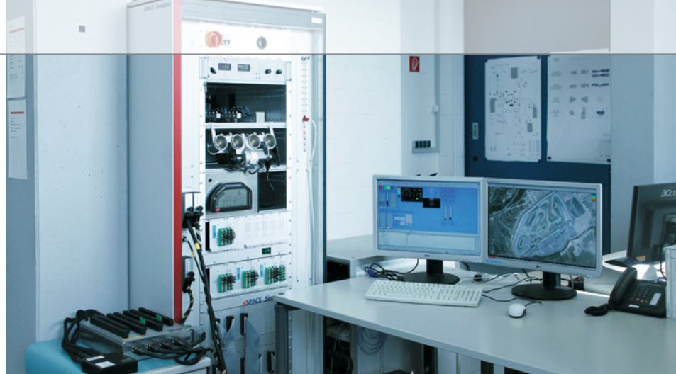
dSPACE HIL テストベンチによる BMW Motorrad Motorsport の RSM5 エンジン ECU の試験施設内でのテスト
