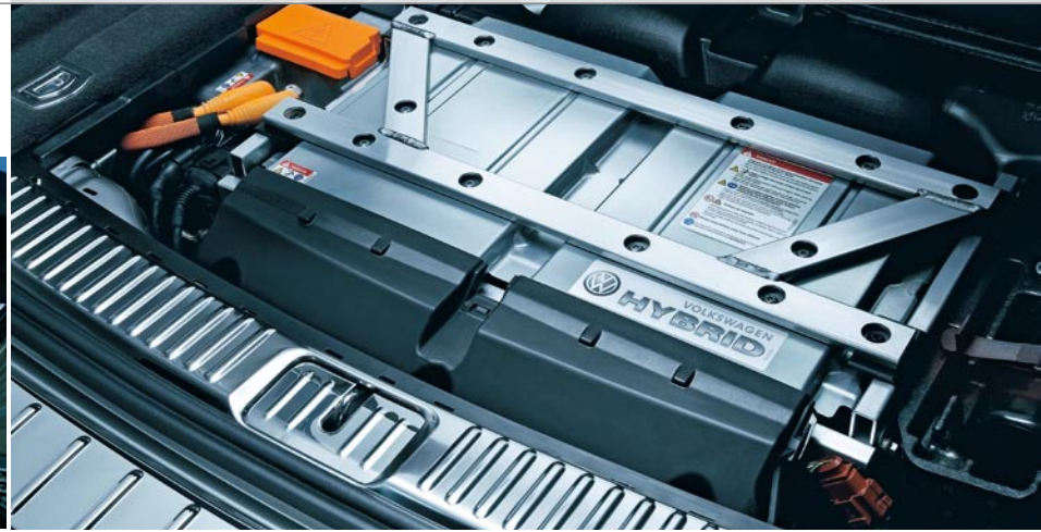
Die NiMH-Batterie ist im Heck verbaut.
