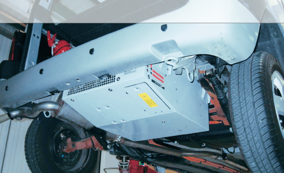
バッテリーパックの車両への組み込み
