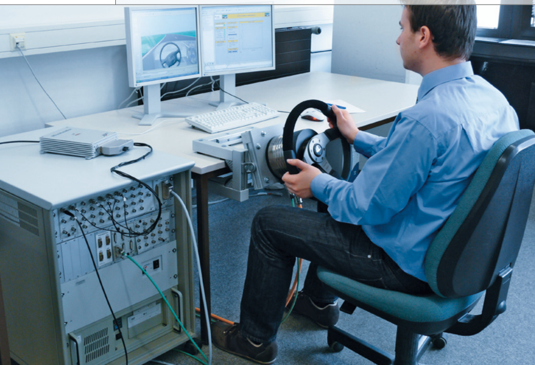
図1：フィードバックステアリングホイールを使用したHILテストベンチ
