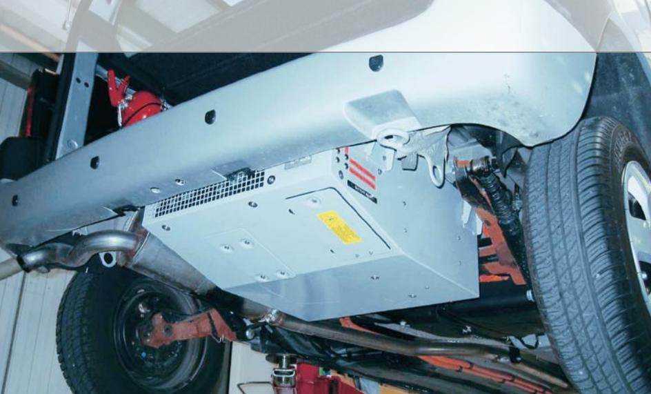
Integration eines Batteriepacks in ein Fahrzeug.
