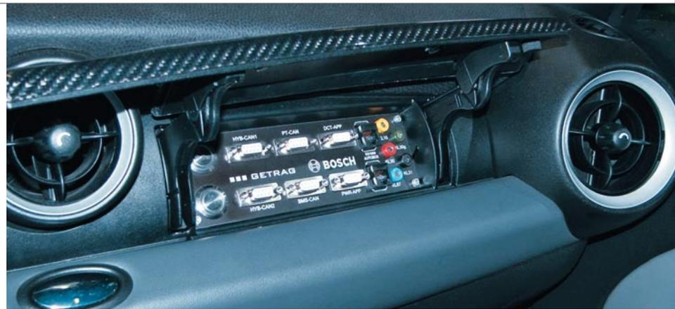
nenten und deren bestmögliche Ausnutzung im Betrieb bestimmen letztlich das erzielbare Verbrauchspotential des Hybridantriebs. Um unterschiedliche Betriebsstrategien untersuchen zu können, sind der Hybridmanager auf einem modifizierten Motorsteuergerät von BOSCH und die Getriebesoftware auf einem dSPACE-System implementiert. Die Hybridisierung des Antriebs-
