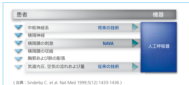
図 2 : NAVA 技術は、横隔膜の電氣的作用を利用して、最も速い段階で検出できる呼吸信号を感知します。
