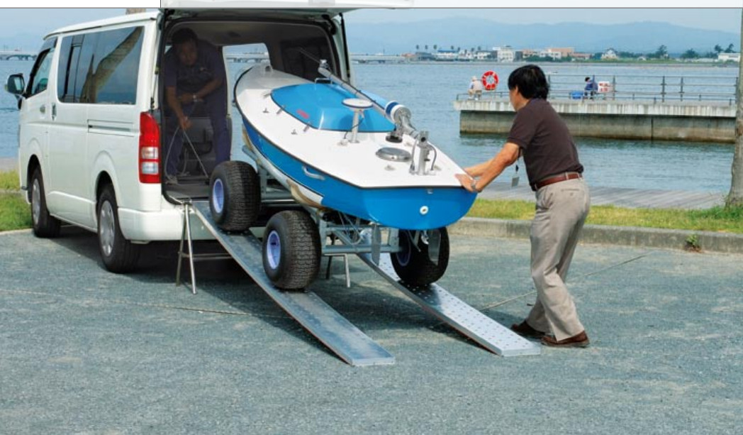
Mit einer Gesamtlänge von lediglich 2,85 Metern lässt sich das Boot bequem in einem Kleintransporter auf der Straße zum Einsatzort transportieren und problemlos zu Wasser lassen.
