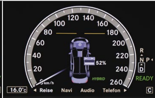
Abbildung 4c: Das Fahrzeug brems bis zum Stillstand (Geschwindigkeit 0 km/h, Verbrennungsmotor und Elektromotor sind abgeschaltet). Der Ladezustand der Batterie hat sich nach dem erneuten Bremsen und Rekuperieren auf 52 % erhöht.
