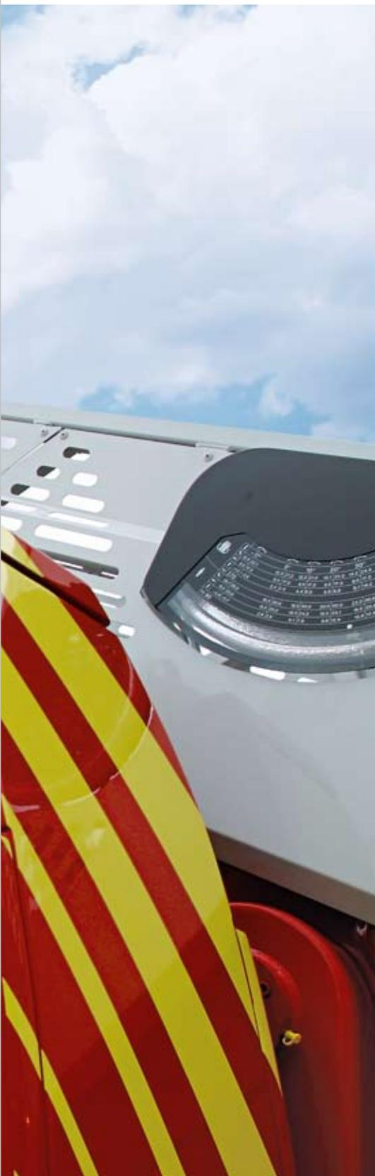
現在、回転梯子には、より高く、より速く、より遠くまで届くこと、そしてより安全であることが求められています。これらの目標を実現するには、軽量の構造が重要になります。新型の軽量梯子が課題とする曲げ振動の発生に対し、ドイツのシュトゥットガルト大学システムダイナミクス研究所では、dSPACE ツールを使用して、IVECO MAGIRUS Brandschutztechnik 社向けのアクティブ減衰制御システムを開発しました。
