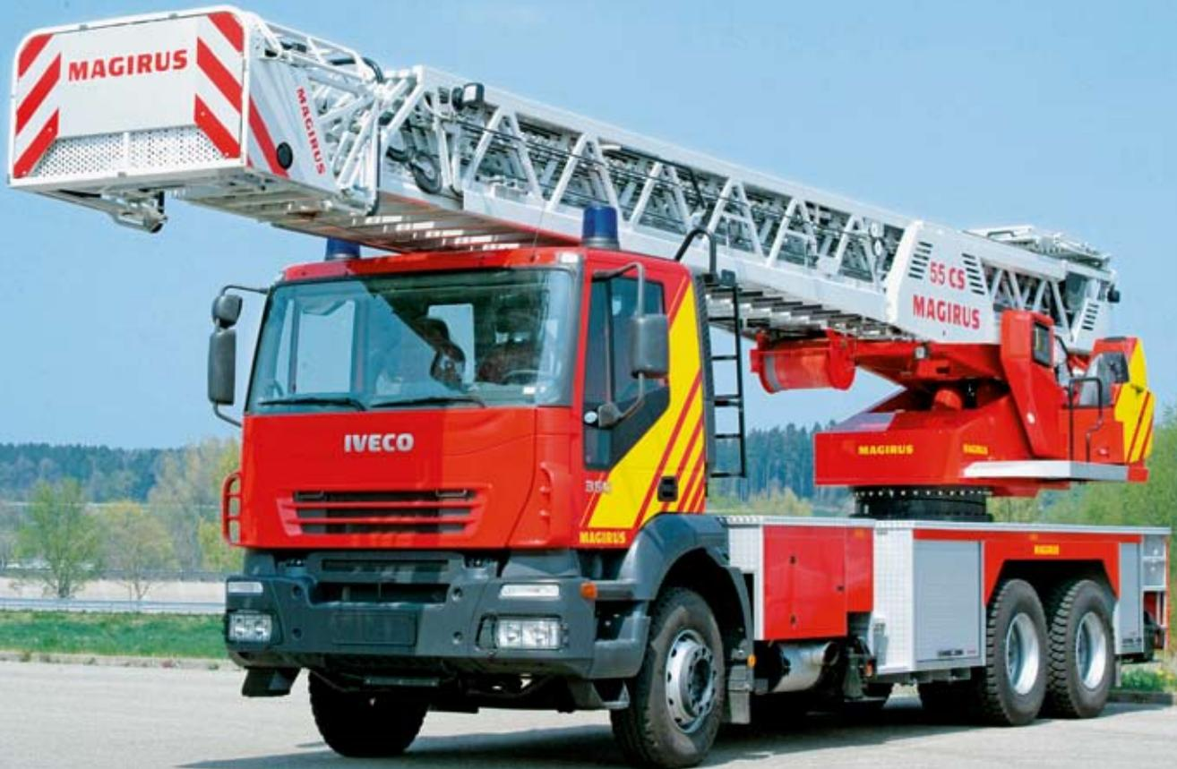
は、IVECO MAGIRUS 社製の CS 梯子の優れたセールスポイントになっています。現在世界中で、その名称に CS の付いた車両が 700 台以上稼動しています。そして、システムダイナミクス研究所は、IVECO MAGIRUS 社と協力を続けながら、より効果的な制御を実現するために研究開発に取り組んでいます。現在、第三世代が生産レベルに達したばかりであり、振動の基本周波数だけでなく、調和振動数もアクティブに減衰するようになっています。
