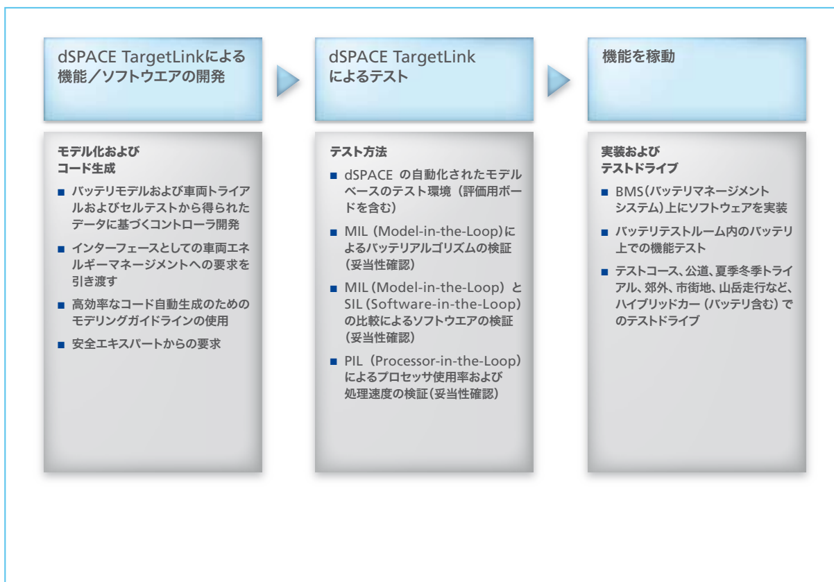
図7：バッテリー管理システム (BMS) のモデルベース開発における主要フェーズと、各フェーズでの開発タスク
