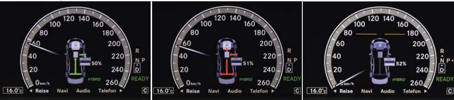
図 4a：走行速度を 60 km/h 以下へ減速中の状態です。モーターがジェネレータとして作動し、車両の運動エネルギーを電気エネルギーへ変換してハイブリッドバッテリーへ充電します（エネルギー回生）。インストルメントクラスタには、バッテリーへ向かうエネルギーの流れが緑の矢印で示されます。現在のバッテリー充電状態は 50 % で、充電が続行中です。
