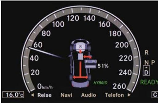
Abbildung 4b: Das Fahrzeug beschleunigt auf über 50 km/h. Der Elektromotor verbraucht Strom aus der Batterie und unterstützt den Verbrennungsmotor beim Antrieb. Im Kombiinstrument wird der Vorgang durch einen roten Energiefluss zu den Rädern dargestellt. Die Batterieladung liegt durch die vorhergehende Rekuperation nun bei 51 %.
