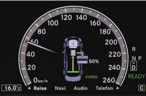
Abbildung 4a: Das Fahrzeug reduziert seine Geschwindigkeit auf unter 60 km/h. Der Elektromotor fungiert als Generator und wandelt die mechanische Bewegungsenergie des Fahrzeugs in elektrische Energie zum Laden der Hybridbatterie (Rekuperation). Im Kombiinstrument wird dieser Vorgang durch einen grünen Energiefluss zur Batterie dargestellt. Die zu 50 % geladene Batterie wird weiter geladen.
